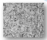
El tipo 304 presenta una estructura de grano austenítico equiaxiado uniformemente.
